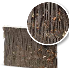
Brez vzdrževanja klimatske naprave
