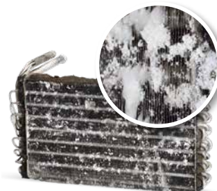
Fără întreținerea climatizării
