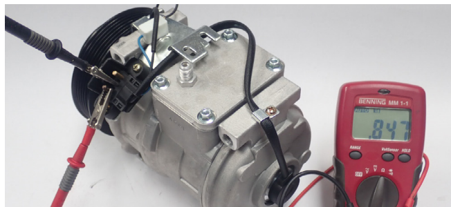
Ilustracja 5: Pomiar rezystancji czujnika prędkości obrotowej
