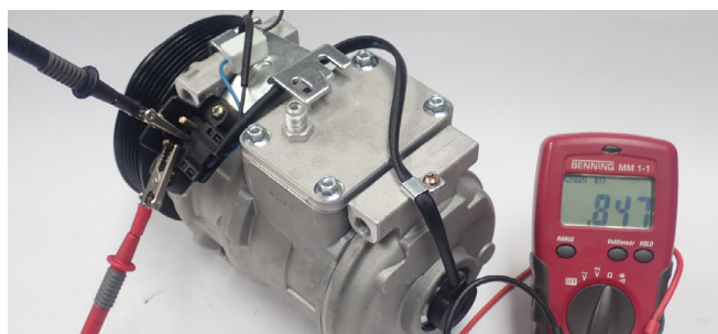
Fig. 5 : Mesure de la résistance du capteur
