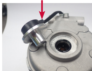
Abbildung 3: Klimakompressor ACP 1712 000S mit Drehzahlsensor
