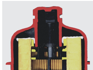
Resim 2: Keçe (beyaz), eksiksiz bir sızdırmazlık gerçekleşecek şekilde, iç çerçeve (sarı) ile dikey boru (kırmızı) arasına monte edilmiş durumdayken preslenir
