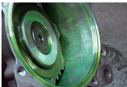
Ilustracja 2: Zbyt duża ilość środka kontrastowego w oleju do kompresora
