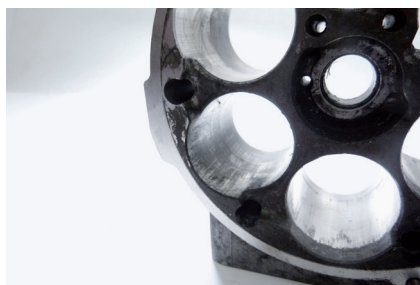
Ilustracja 1: Zatarcie tłoków na kompresorze klimatyzacji ze względu na zbyt dużą ilość środka kontrastowego
