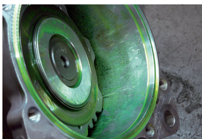
Figure 2 : Surdosage de traceur dans l'huile pour compresseur
