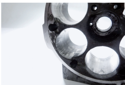
Figura 1: Gripado del pistón del compresor de A/C por exceso de medio de contraste
