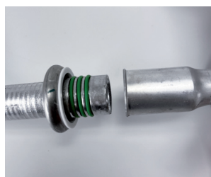
Ilustracja 1: Rozpięte połączenie typu spring lock
