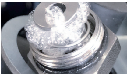
Figure 1 : Fluide frigorigère polymérisé dans le raccord
