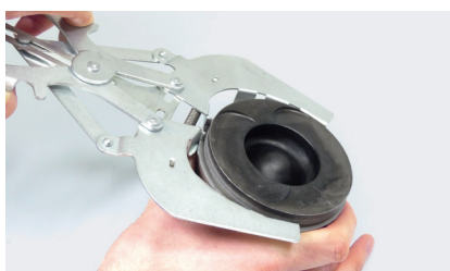
Figure 2 : Monter les bagues à l'aide d'une pince à segments de piston appropriée.
