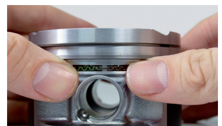
Abbildung 3: Beide Farbmarkierungen der Lamellen müssen sichtbar sein.
