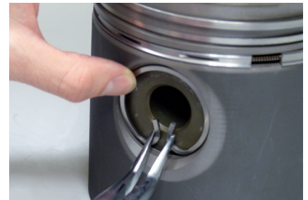
Abbildung 3: Ringöffnung in diesem Fall auf 6 oder 12 Uhr
