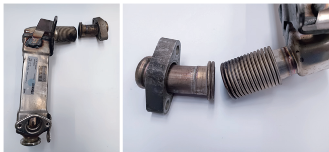
Ilustracja 1: Chłodnica spalin z pękniętym przewodem elastycznym
