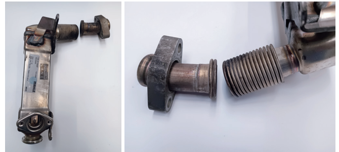
Abbildung 1: Abgaskühler mit gerissenem Flexrohr
