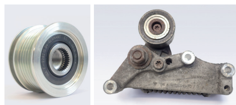
Ilustracja 3: Zawsze należy kontrolować alternator ze sprzęgłem jednokierunkowym i tłumikiem napięcia paska
