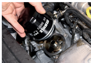
Zdjęcie 2: Nowy filtr jest dokręcany ręcznie.
