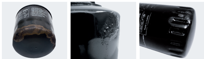
Zdjęcie 3: Wkręcany filtr oleju może ulec uszkodzeniu w wyniku korozji.
