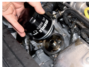
Abbildung 2: Der neue Filter wird von Hand festgezogen.
