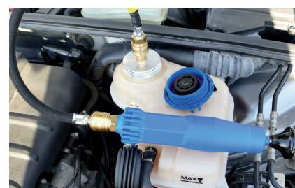
Figure 2 : Des adaptateurs spéciaux permettent également de comprimer et de contrôler la vanne dans le couvercle.
