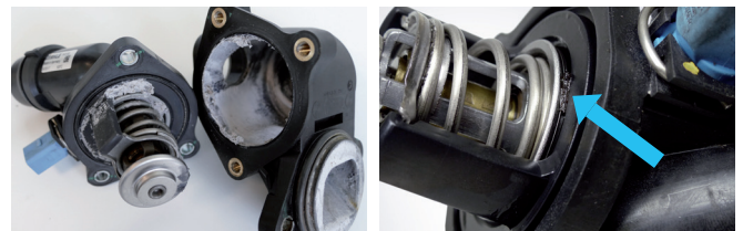
Abbildung 2: Dichtmittel, Fremdkörper und Rückstände führen zu Fehlfunktionen und Blockaden des Thermostats
