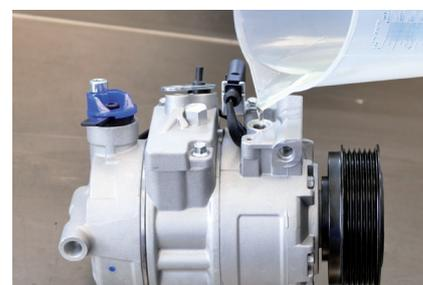
Abbildung 3: Ein R134a-Kompressor mit PAG-46-Ölfüllung kann ebenso mit dem Öl PAO 68 ergänzt werden
