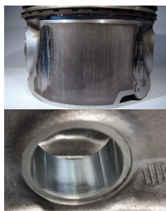
Figure 1 : Traces de grippage sur la jupe de piston et l'alésage de l'axe
