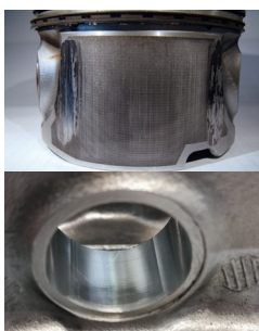
Abbildung 1: Fressspuren an Pleuellagerbuchse und Pleuellagerbohrung
