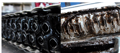
Figure 1 : Joints en caoutchouc décomposés par l'huile
