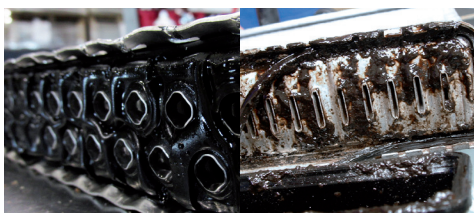
Abbildung 1: Durch Öl zersetzte Gummidichtungen
