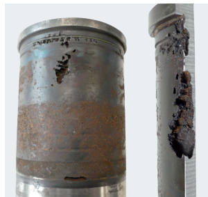
Abbildung 2: Laufbuchse mit Kavitationsschaden im Bereich des oberen Totpunkts
