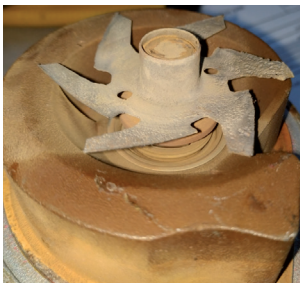
Abbildung 1: Durch Kavitation abgetragene Flügel einer Kühlmittelpumpe
