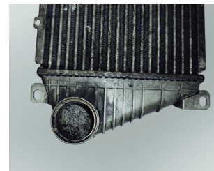
Zdjęcie 2: Wióry pochodzące ze zniszczonego wirnika sprężarki w chłodnicy powietrza doładowującego
