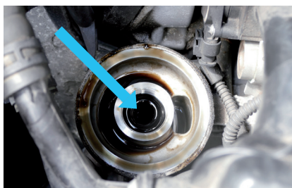
Ilustracja 2: Widok z góry na kołnierz filtra oleju i zamontowaną rurkę (strzałka)
