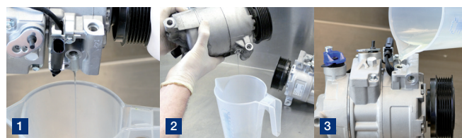
Zdjęcie 2 1. Spuścić olej z nowego kompresora. 2. Spuścić olej ze starego kompresora i określić jego ilość. 3. Ponownie napełnić nowy kompresor zredukowaną ilością świeżego oleju.
