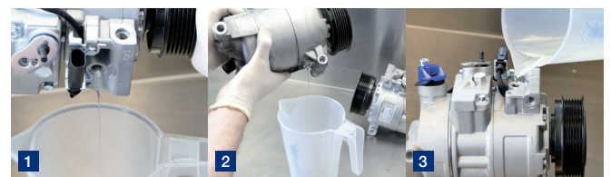
Figura 2: 1. Purgar por completo el aceite del nuevo compresor. 2. Purgar por completo el aceite del compresor usado y calcular la cantidad. 3. Volver a llenar el nuevo compresor con una cantidad reducida de aceite fresco.
