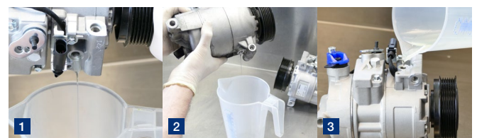
Abbildung 2: 1. Öl aus dem neuen Kompressor vollständig ablassen. 2. Öl aus dem alten Kompressor ablassen und Menge ermitteln. 3. Neuen Kompressor mit reduzierter Menge Frischöl wieder befüllen.
