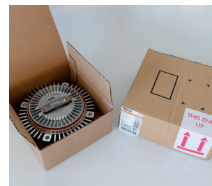
Figura 2: Posición de almacenamiento correcta de un embrague Visco® de bimetalo (según la rotulación del embalaje, con la franja de bimetalo apuntando hacia arriba)
