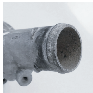
Figura 3: Limpiar con cuidado las superficies corroídas antes de realizar de nuevo el ensamblaje
