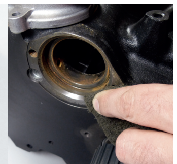
Abbildung 3: Korrodierte Flächen vor dem Zusammenbau sorgfältig reinigen
