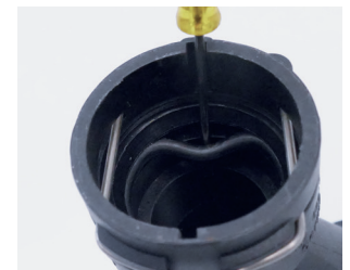
Abbildung 2: Alte Dichtung im Flansch mit geeignetem Werkzeug entfernen und ersetzen
