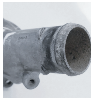
Abbildung 3: Korrodierte Flächen vor dem Zusammenbau sorgfältig reinigen
