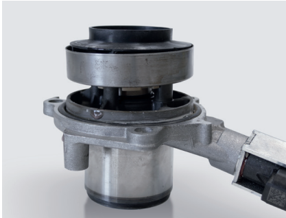
Resim 1: Takılıp kalan kayan sınırlayıcıya sahip kontrollü soğutma sıvısı pompası (sirkülasyon yok)
