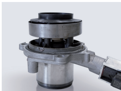
Zdjęcie 1: Regulowana pompa chłodziwa z zaciętą przesłoną (brak cyrkulacji)
