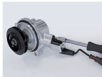
Zdjęcie 3: Nowa, nieregulowana pompa chłodziwa z zamontowanym elementem sterującym
