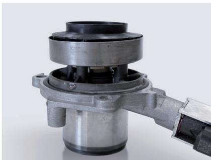
Abbildung 1: Geregelte Kühlmittelpumpe mit festsitzender Schieberblende (keine Zirkulation)
