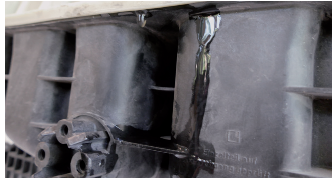
Resim 3: Taşan soğutma sıvısı, genişleme haznesindeki ayırma hattı alanından tekrar dışarı sızar
