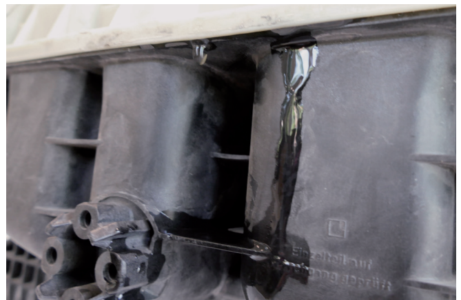
Abbildung 3: Übergelaufenes Kühlmittel tritt im Bereich der Trennfuge am Ausgleichsbehälter wieder aus
