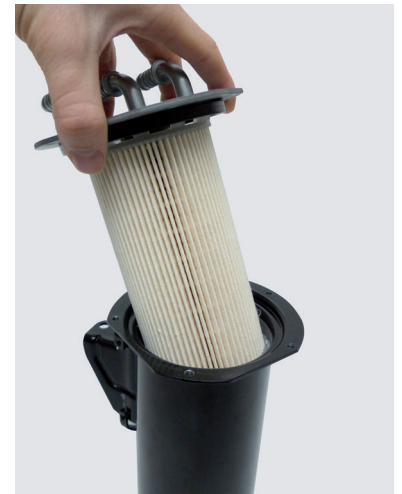
Abbildung 3: Je nach Bauart sollte der Filter zuerst im Gehäusedeckel befestigt werden.
