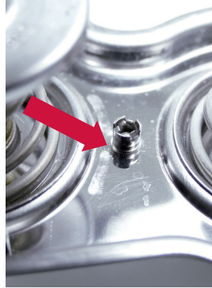
Resim 1 ve 2: Farklı termostat tasarımlarında, termostat tablasındaki bilyeli supaplar (ok işareti)
