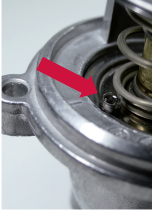
Resim 1 ve 2: Farklı termostat tasarımlarında, termostat tablasındaki bilyeli supaplar (ok işareti)
