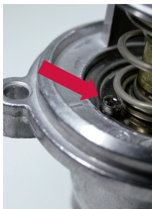
Figures 1 et 2 : Soupapes à bille (flèche) sur la platine de différents types de thermostats
