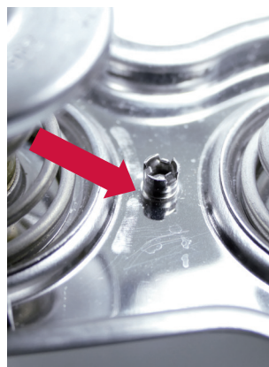
Figures 1 et 2 : Soupapes à bille (flèche) sur la platine de différents types de thermostats
