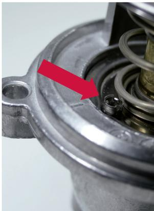
Figuras 1 y 2: Válvulas esféricas (flecha) en el plato del termostato en distintos modelos de termostato
