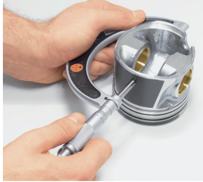
Resim 2: Çap, piston eteği üzerindeki pim eksenine dik açıda ölçülür
