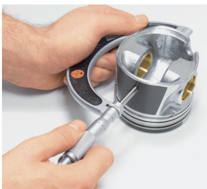
Figura 2: El diámetro se mide en ángulo recto respecto al eje de bulón en la falda
