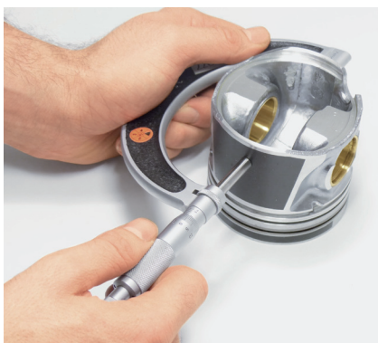
Figure 2 : Le diamètre est mesuré au niveau de la jupe à angle droit par rapport à l'axe du piston.
