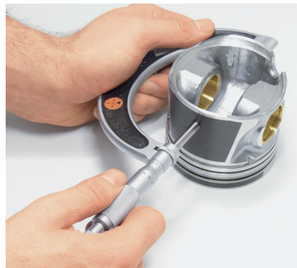
Abbildung 2: Der Durchmesser wird rechtwinklig zur Bolzenachse am Schaft gemessen
