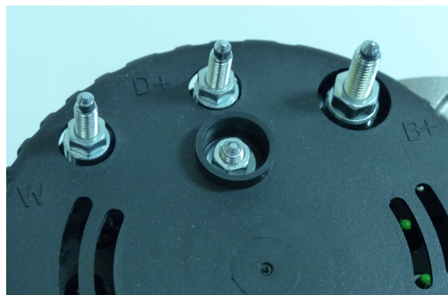
Zdjęcie 2: Oznaczenie zacisków generatora: W = sygnał prędkości obrotowej, D+ = kontrolka ładowania i B+ = plus akumulatora
