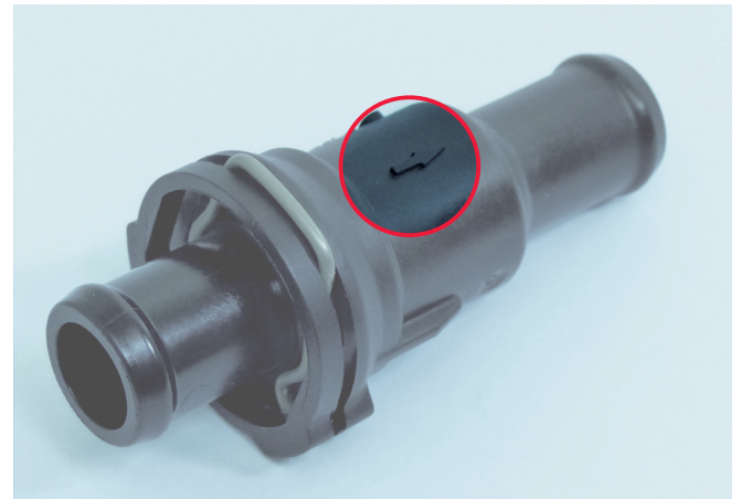
Figure 2 : Très important lors du remplacement du thermostat : respecter le sens de montage (flèche) !
